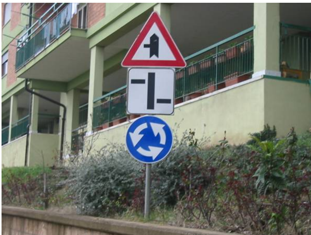
Figura 16 Insieme di segnali che crea confusione: problema di grado lieve.
