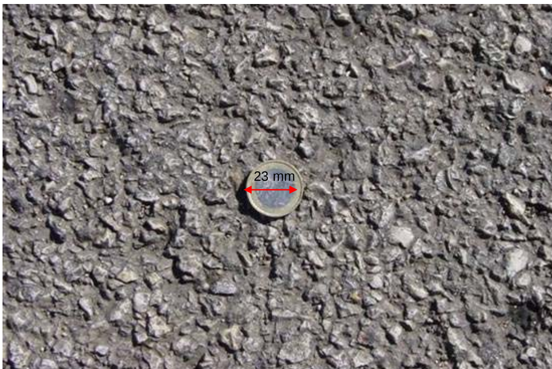
Figura A11 - Aggregati superficiali levigati.
