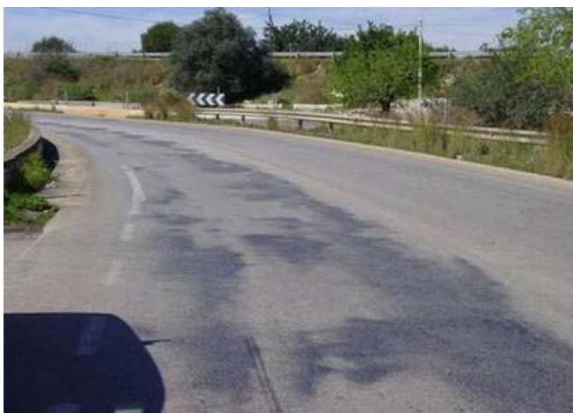
Figura A3 - Errata delineazione: delineatore di curva stretta o tornante in luogo dei delineatori modulari di curva.
